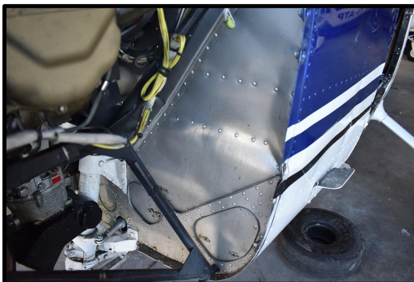
Fotografía No. 12 Daño en pared de fuego.
