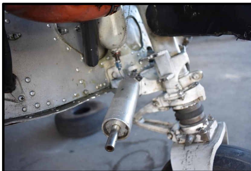
Fotografía No.14 Fractura del soporte del amortiguador de vibración (Shimmy Damper).
