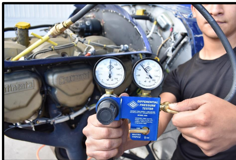
Fotografía No. 13 Chequeo diferencial de compresión de los cilindros del motor.
