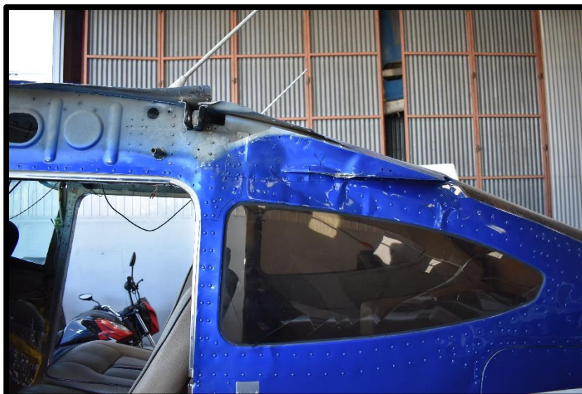
Fotografía No. 11 Daño a la estructura en la parte superior de la cabina.
